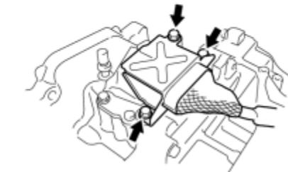
(d) Connect the generator cable clamp to the motor cable bracket.
