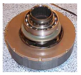
Fig. 2.7. 2004 Prius generator rotor.
