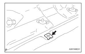
(d) Remove the nut from the fuel tank.
