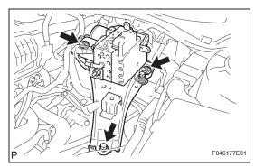
(j) Install the brake actuator.
