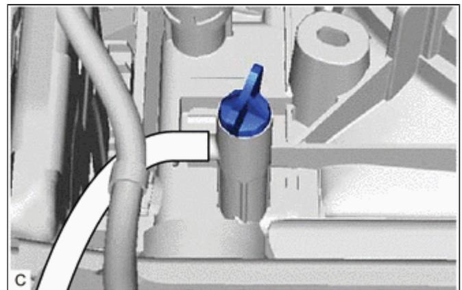
(d) Tighten the drain cock plug by hand.
