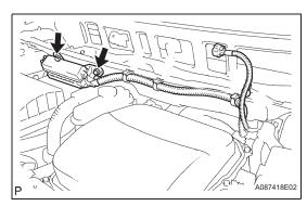
4. INSTALL ENGINE ROOM NO. 2 RELAY BLOCK
