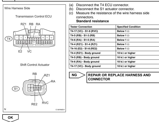
4 CHECK WIRE HARNESS (TRANSMISSION CONTROL ECU - BODY GROUND)
