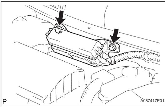
2. **INSTALL ENGINE ROOM NO. 2 RELAY BLOCK**
