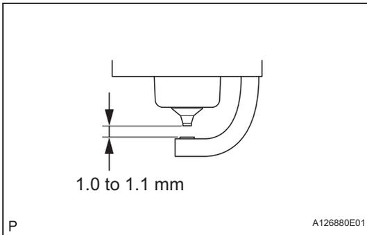
(d) Check the spark plug electrode gap.
