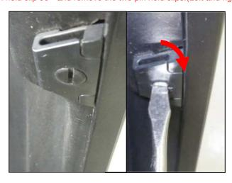
④ スクリューを取り外します。(左右) (4) Remove the screw. (Left and Right)
