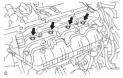
(d) Remove the 4 injector vibration insulators.
