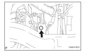
(d) Remove the 4 nuts and the brake pedal support.
